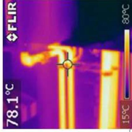
**Perte de chaleur d'un tuyau en acier non isolé en [W/m]**
